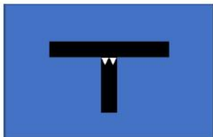
Figur 7. Krydsning mellem to stier: afmærkning af vigepligt med højttænder. Ingen bomme.
